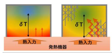
蓄熱ユニット内部はPCMが封入されており、融点を挟んで 潜熱による蓄熱が行われる。蓄熱材(PCM)の多くは熱伝 導率が低いため熱授受面から大きな温度差が発生してし まう(上図左)。一方本品は緻密に配置された伝熱フィンに より、温度差を小さくできる(上図右)ため、PCMに効率よく 熱を伝達することに成功した。
